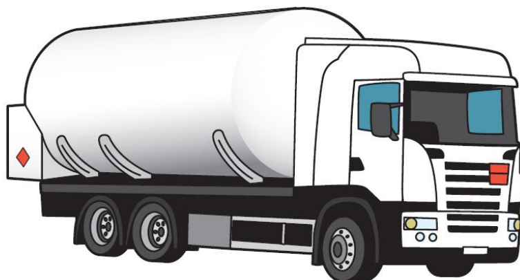
Figur 4.1 Tankbil med eller utan släp. Pumpsåp med manöverfunktioner baktill.
