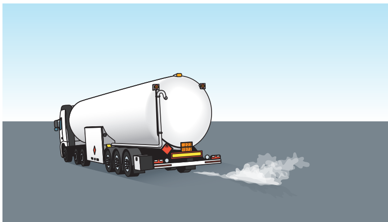
Figur 3.6 Flytande metan på nedkyld mark ca 20 \text{ m}^3/\text{h}/\text{m}^2 .
