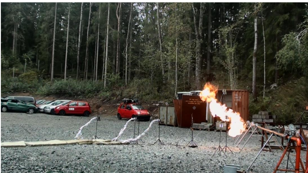
Figur 34. Karakteristisk flamma för test 5
