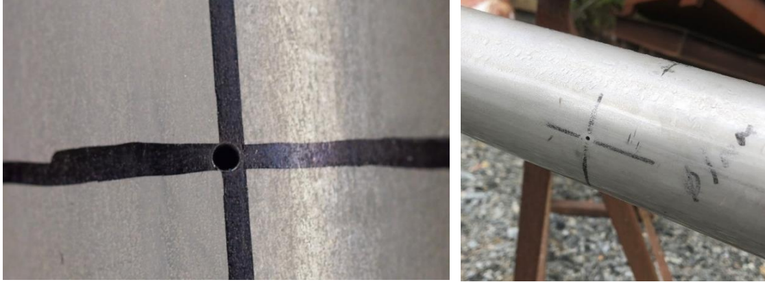
Figur 4. Teststycke 3. Rör med borrarat hål
