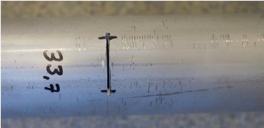
Figur 2. Teststycke 1. Rör med sågad slits.
