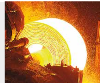
Storförbrukare. Ståljätten SSAB i Borlänge använder 70 000 ton gasol om året som bränsle i varmvalsningen av stål till plåt.
