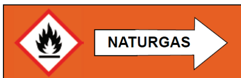
Bild 3 Exempel på märkning av gasledning.
