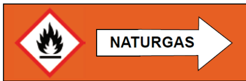
Bild 3 Exempel på märkning av gasledning
