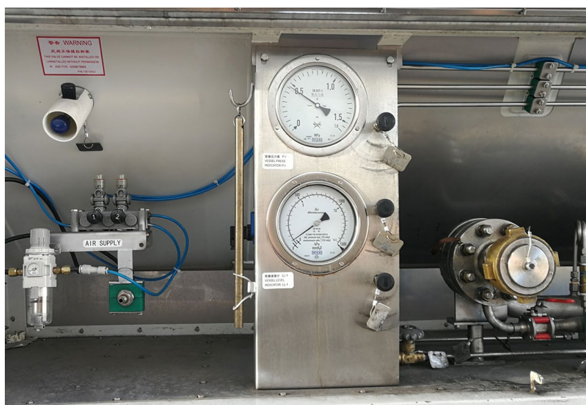
Figur 4.10 En tankcontainers säkerhetsventiler och avblåsningssystemets mynning på en tankcontainer ses inom stålramen.
