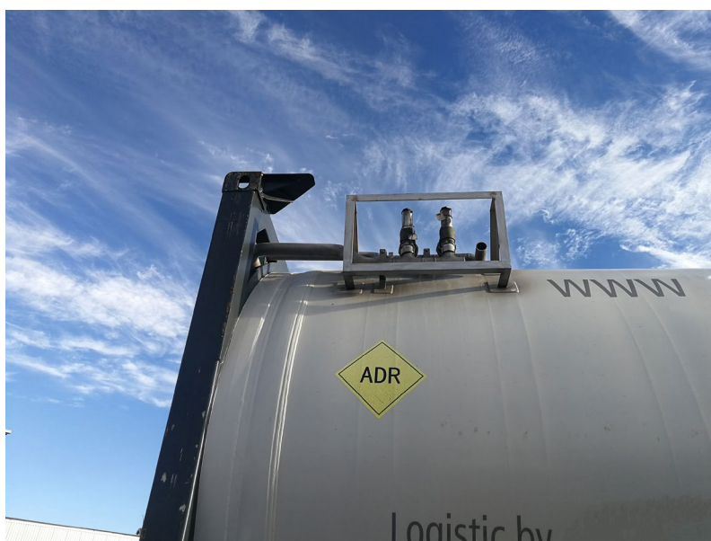
Figur 4.10 En tankcontainers säkerhetsventiler och avblåsningssystemets mynning på en tankcontainer ses inom stålramen.
