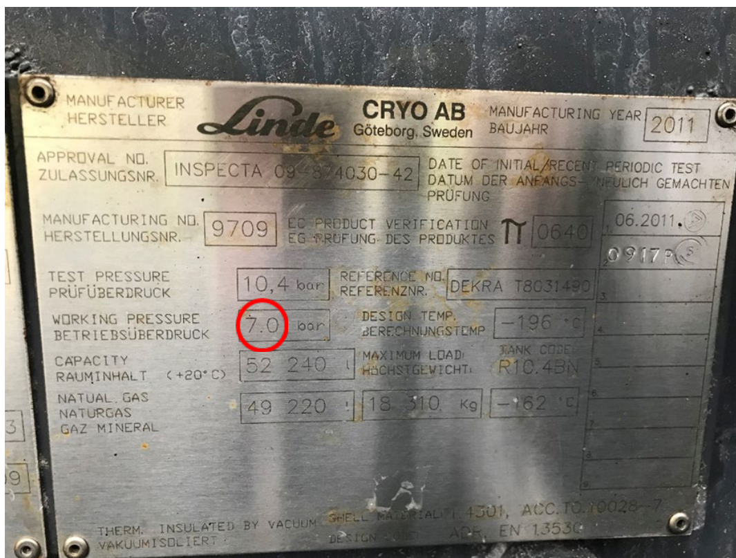
Figur 4.5 På främre delen av chassit eller på transportenhetens pumpskåp finns tillverknings-skylt. Här finns information om säkerhetsventilernas öppningstryck (inringat i rött).
