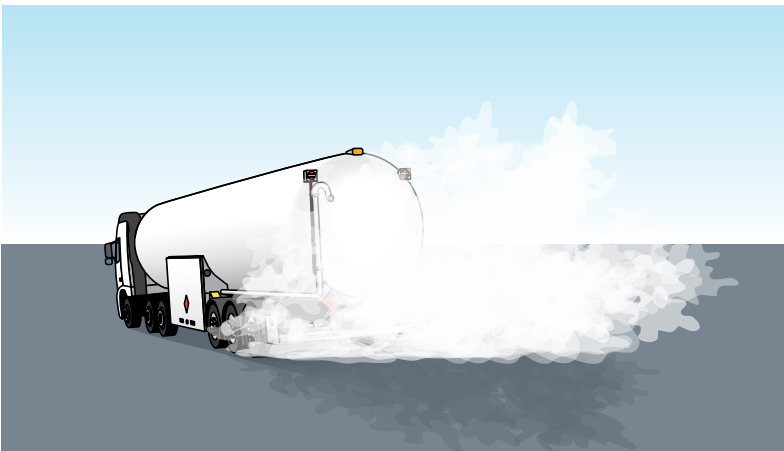
Figur 3.5 Flytande metan på ej nedkyld mark ca 200 \text{ m}^3/\text{h}/\text{m}^2 .
