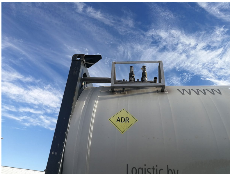
Figur 4.10 En tankcontainers säkerhetsventiler och avblåsningssystemets mynning på en tankcontainer ses inom stålramen.
